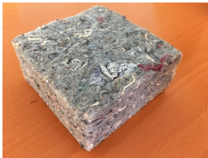
Fibres issues du recyclage : - Fibres issues de textiles de récupération en panneau. - Fibres issues de papier recyclé (ouate de cellulose) en vrac. © CAUE de la Haute-Marne
