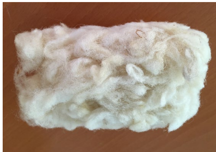
Des isolants en fibres animales : - Laine de mouton en vrac. © CAUE de la Haute-Marne
